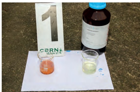
Obr. 9 - Porovnání reakce Nesslerova činidla na páry amoniaku (kontrolní vzorek z pokoje č. 7) a neexponovaného Nesslerova činidla (zdroj: VAKOS XT)
