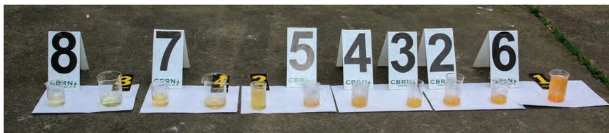
Obr. 10 - Koncentrační řada jednotlivých vzorků po provedení permeačního testu (zdroj: VAKOS XT)
